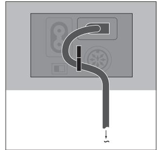
**Kabelklemme:** Aus Sicherheitsgründen muss das mit der Netzdose verbundene Netzkabel am Lautsprecher befestigt werden. Ziehen Sie das Kabel hierzu hinter die Klemme.
