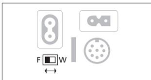
*Der POSITION-Schalter befindet sich am Lautsprecher-Anschlussfeld.*
