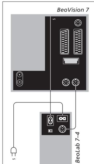
Die beiden Netzkabel und das Power Link-Kabel liegen dem BeoVision 7 bei.
