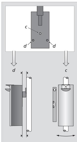
**Einstellungen:** Benutzen Sie die beiden Schrauben (d), um den Lautsprecher zum Standfuß bzw. zur Wandhalterung auszurichten. Positionieren Sie den Lautsprecher dann so, dass die Seite vertikal steht, und ziehen Sie abschließend die Schraube (c) an.
